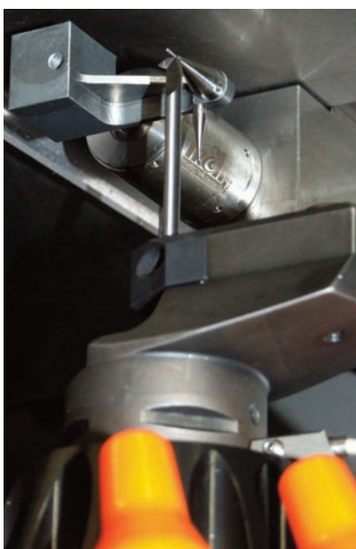
Qualitativ gute Schnitten erfordern das Messen schon in der Maschine.
