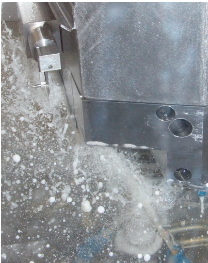
In den Schleifmaschinen bei Horn stehen die m&h-Messtaster im Dauerregen von Emulsion und Schleifabtrag.
