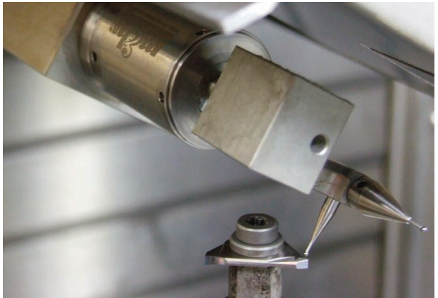
Les palpeurs de production de m&h peuvent être utilisés dans toutes les positions
