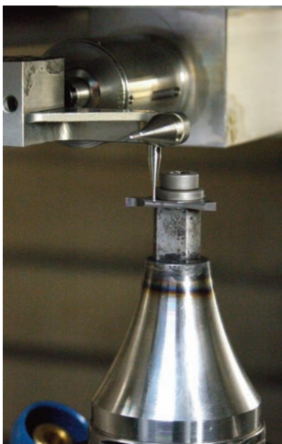
Des possibilités d'installation simples et des stylets spécifiques permettent de la grande flexibilité d'application au palpeur m&h.
