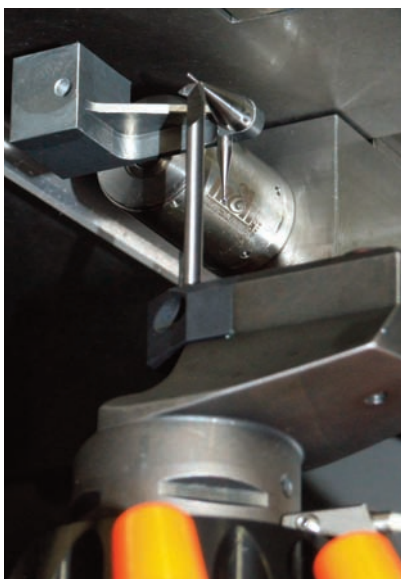
Les outils coupants de haute qualité doivent être mesurés dans la machine
