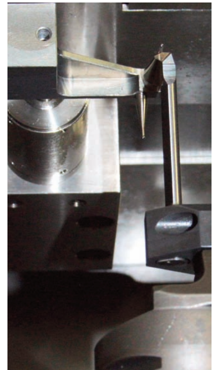
Mesurer en cours de processus permet d'obtenir des pièces affûtées précises même dans la fabrication automatisée
