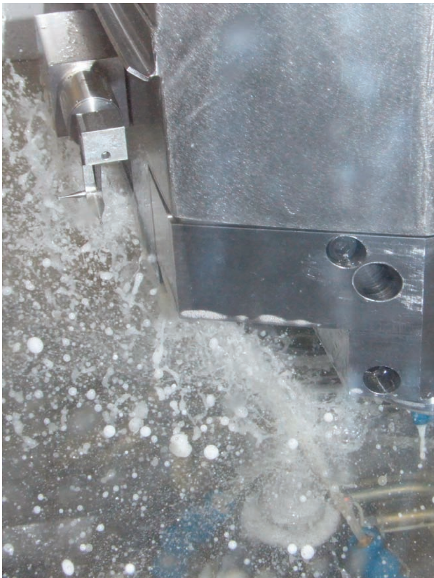
Le corps du palpeur en acier inoxydable le prédestine à l'usage d'émulsions d'affûtage
