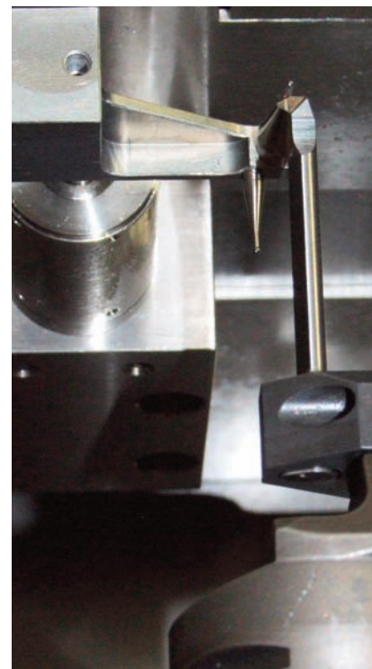
La misurazione in-process garantisce parti rettificate di precisione durante la produzione automatizzata.
