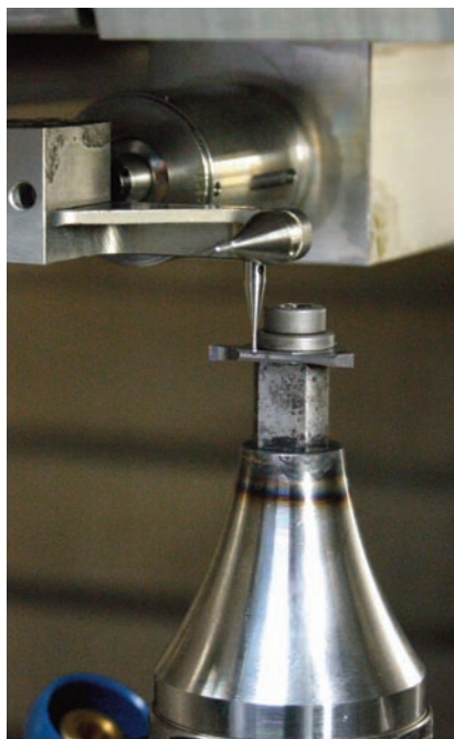
Quando si scende nell'ordine dei micron, Horn utilizza il tastatore m&h.
