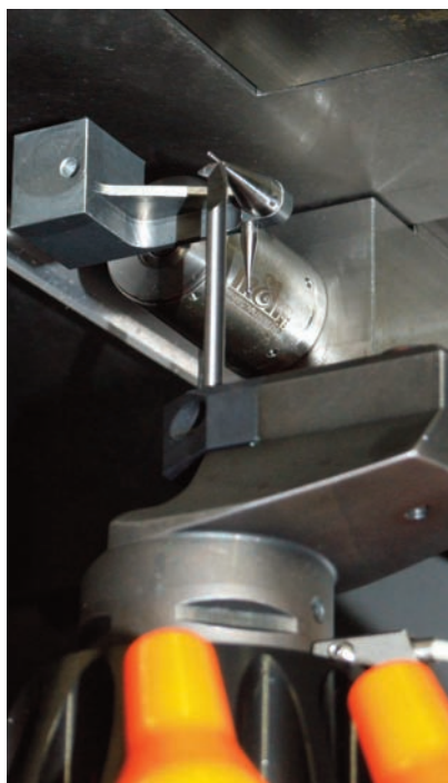
Taglienti di alta qualità richiedono una misurazione in macchina.
