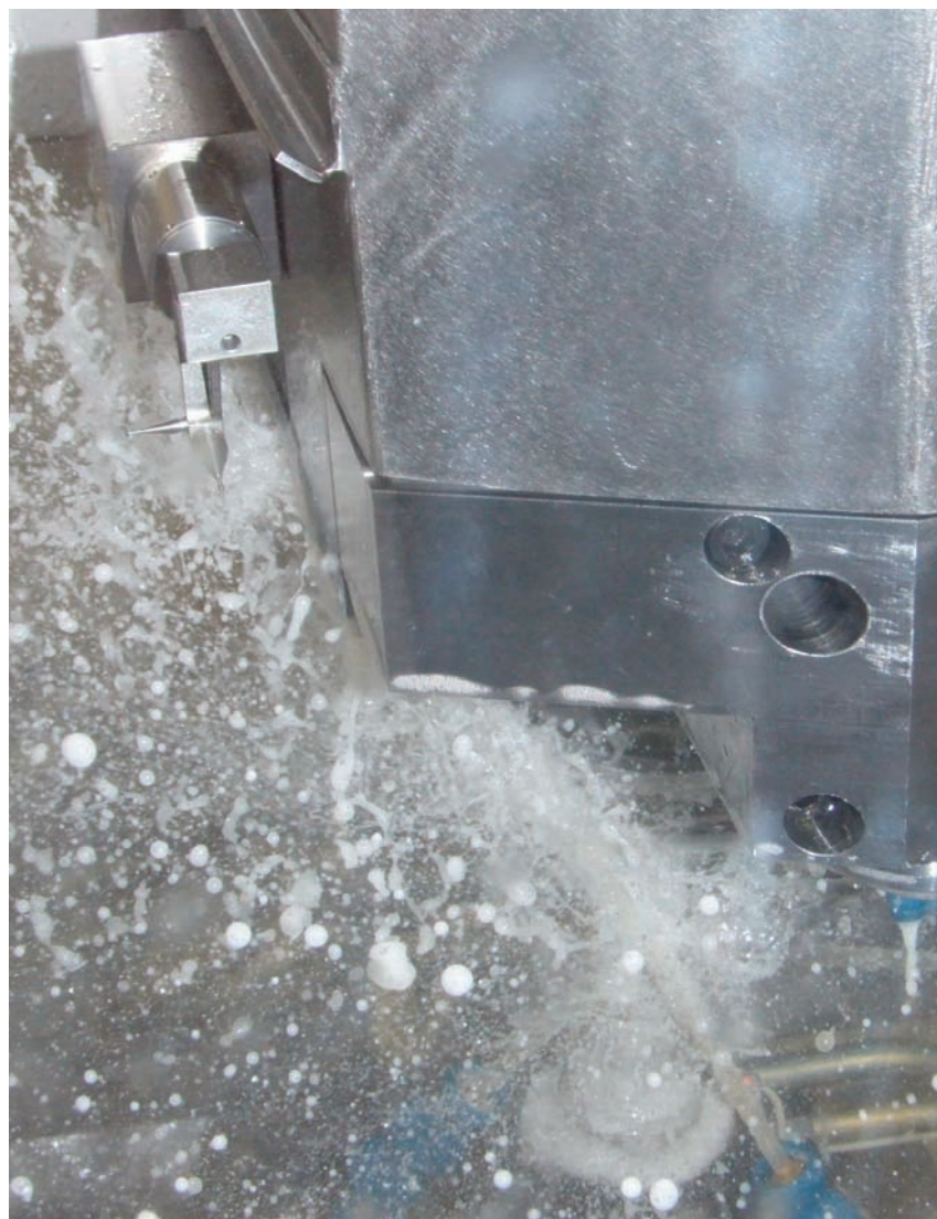
Il corpo del tastatore è fatto di acciaio inossidabile per essere utilizzato con tutti i fluidi di rettifica.
