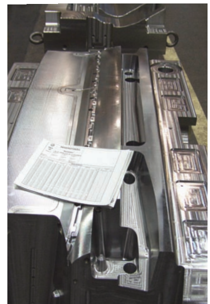
Besonders große Werkstücke werden mit m&h auf der Maschine gemessen und mit Messprotokoll dokumentiert
