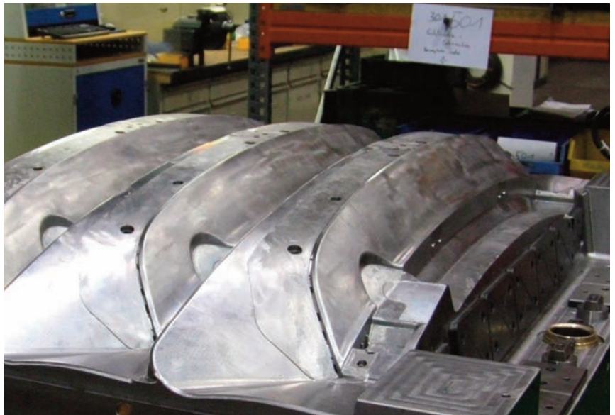
Große Formkerne mit Freiformflächen werden mit m&h auf Formtreue geprüft bevor sie aus der Spannung gelöst werden.
