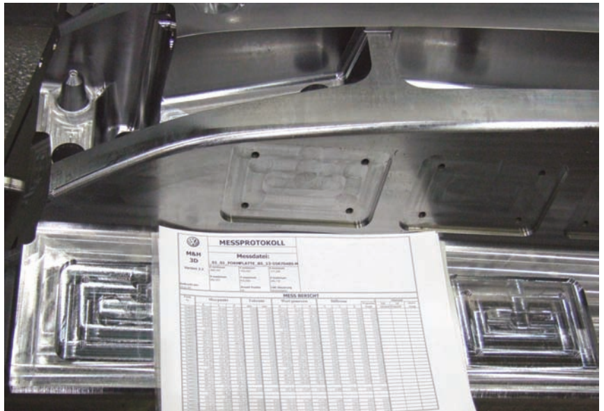
Werkstücke werden erst von der Maschine genommen, wenn das m&h Messprotokoll die Genauigkeit bestätigt.
