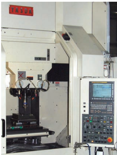
Taster und Software von m&h prüfen das Werkstück auf einer YASDA mit Fanuc-Steuerung.
