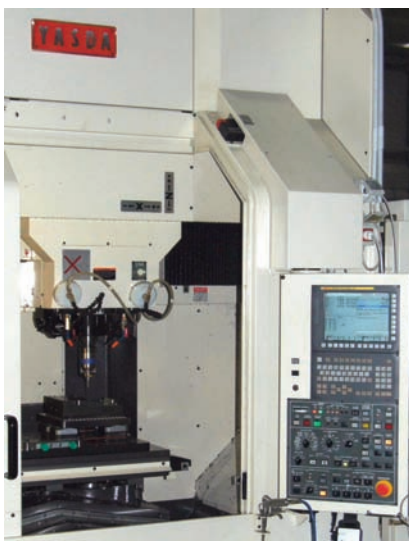
Palpeurs et logiciel m&h lors de la vérification de la pièce dans une YASDA avec la commande Fanuc.
