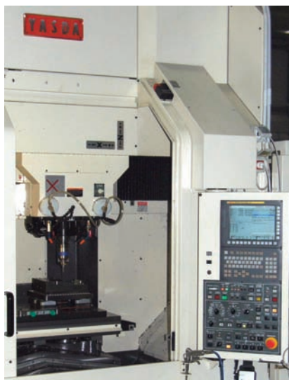
Tastatore e software di m&h verificano il pezzo su una macchina YASDA con CNC Fanuc
