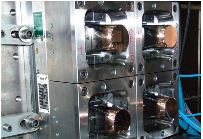
Des surfaces brillantes et des empreintes fidèles aux plans garantissent l'obtention de pièces absolument identiques.
