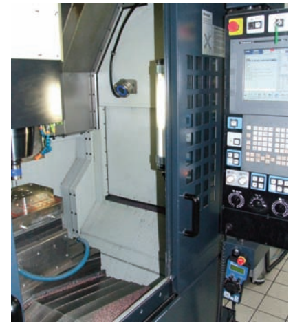
Le récepteur à infrarouge transmet les signaux du palpeur de mesure de m&h à la commande Fanuc de la V33 de Makino.
