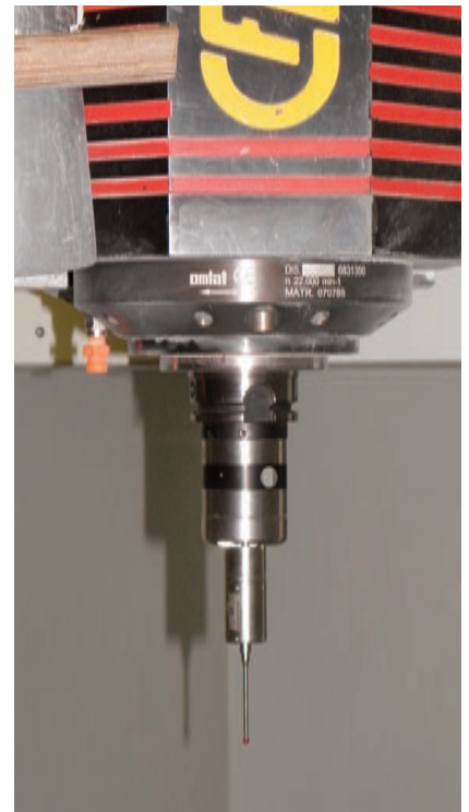
Die Fünfachmaschinen sind mit m&h Messtastern mit Funkübertragung ausgerüstet
