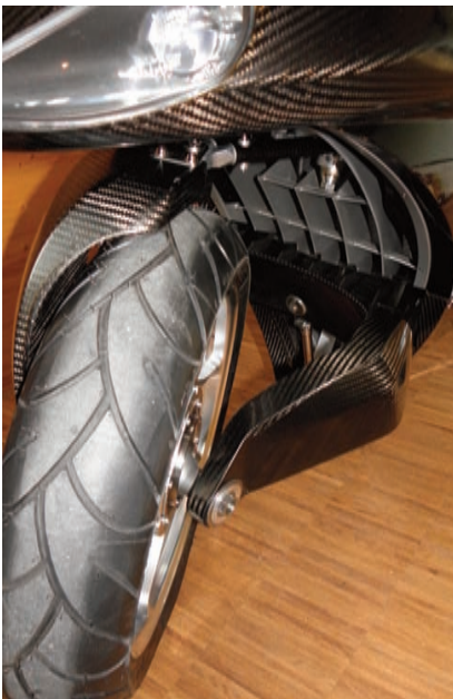
Besonders anspruchsvoll in Sachen Genauigkeit ist die Einarmschwinge aus Kohlefaserverbundwerkstoff
