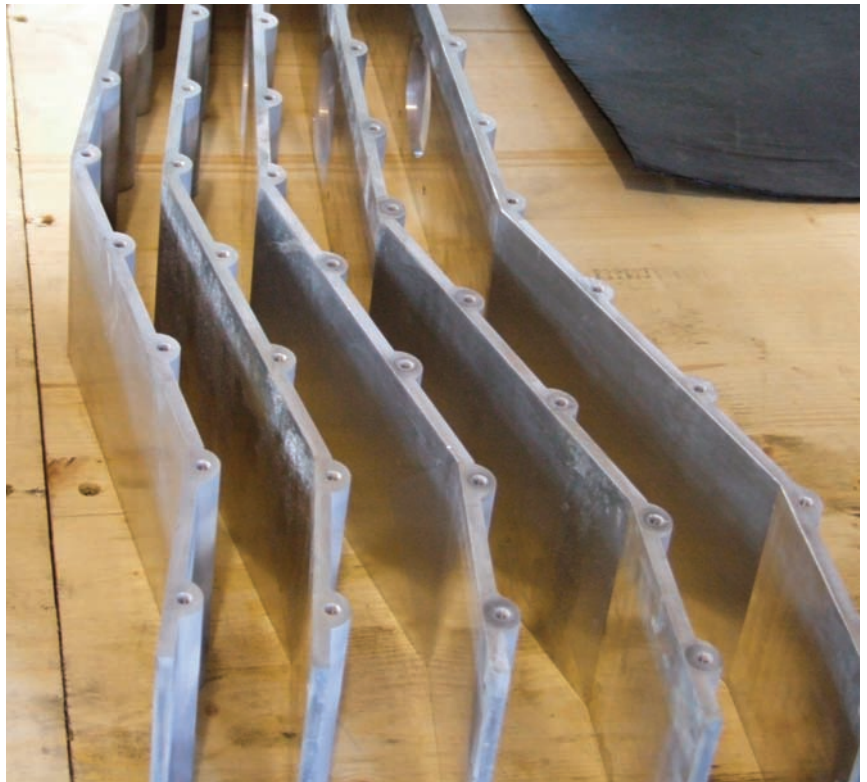
Viele Werkstücke werden gefräst und Drahterodiert, so wie diese Strukturen
