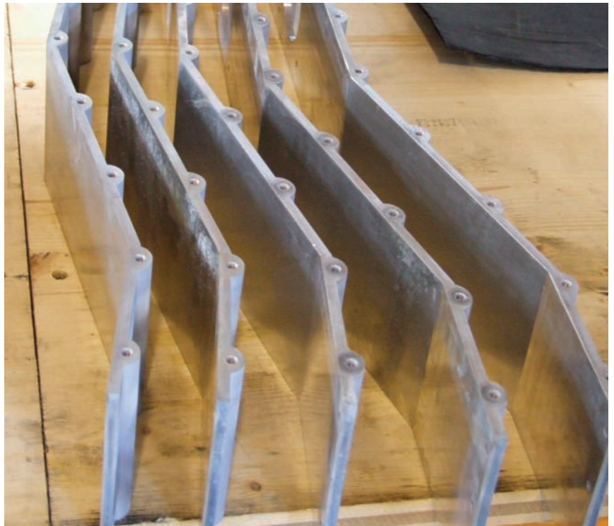
Plusieurs pièces, comme ces structures, sont fraisées et érodées par fil
