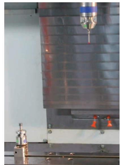
Les palpeurs outils amovibles et les palpeurs pièce de m&h communiquent avec la commande avec le même récepteur infrarouge
