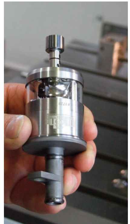
Le palpeur outil amovible de m&h est petit, robuste, et étanche selon la norme IP 68 (au fond de la station d'arrimage)
