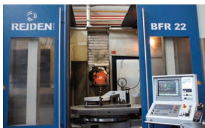
Misura di fusioni su una macchina a 5 assi REIDEN BFR 22
