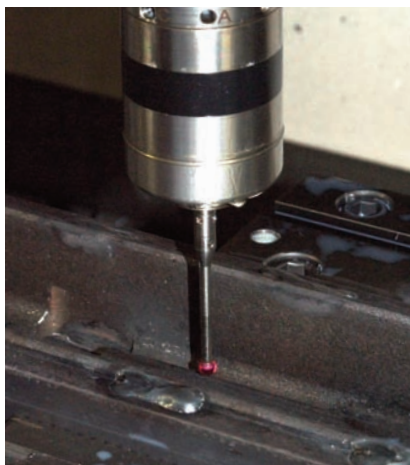
Misura della deformazione di saldatura prima di iniziare la lavorazione
