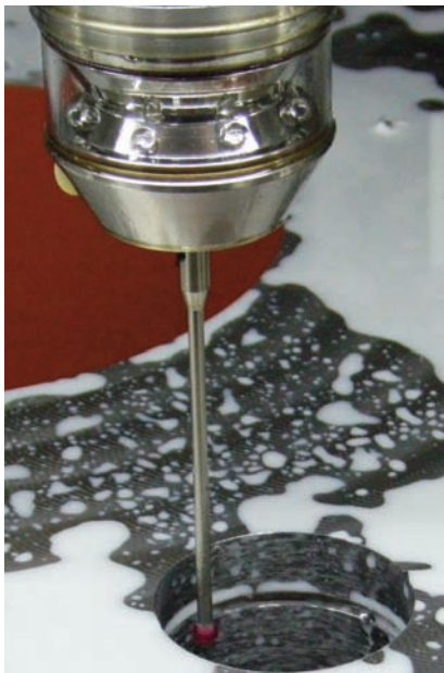
Positionsbestimmung und Passmaßermittlung mit 3D Form Inspect
