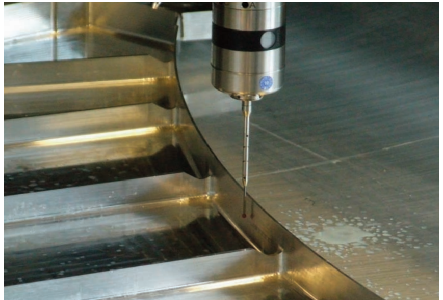
Dünne Stege werden noch in der Spannung auf der Maschine gemessen
