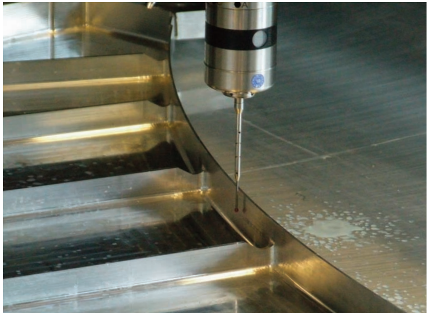
Le sezioni trasversali sottili sono misurate quando ancora staffate in macchina.
