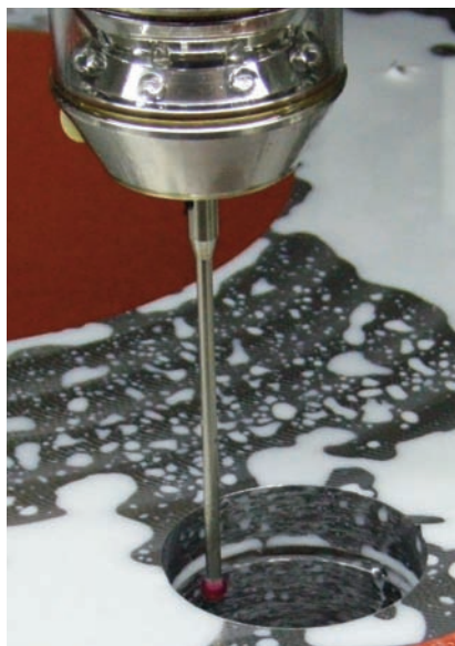
Determinazione della posizione e del grado di accoppiamento con 3D Form Inspect
