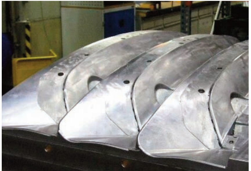
Le superfici senza matrice nei nuclei per componenti di autoveicoli VW sono controllate con 3D Form Inspect.
